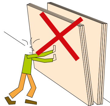
Abb. 51 Unzulässiges „Blättern“ in einem Plattenlager
