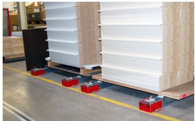
Abb. 70 und 71 Beispiele für Ablaufsicherungen an Rollenbahnen
