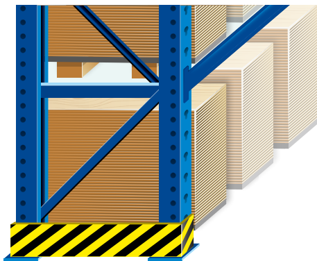
Abb. 66 Regal mit Anfahrtschutz
