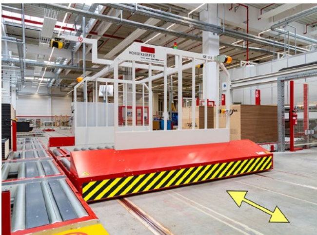
Abb. 87 Absicherung im Bodenbereich durch Bumper
