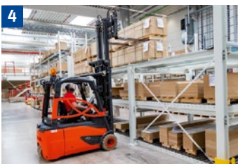
4 Mit hochgestellter Last nur zum Auf- und Absetzen verfahren. Hubgerüst nur über Stapelfläche nach vorne neigen.
