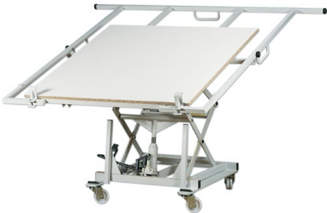
Abb. 29 Durch Plattenschwenkwagen entfällt manuelles Heben und Tragen
