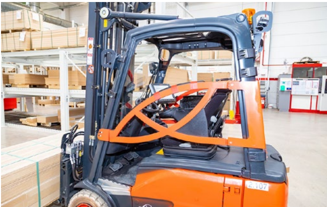
Abb. 17 Fahrerrückhalteeinrichtung (hier: Bügeltür) bei jeder Fahrt benutzen
