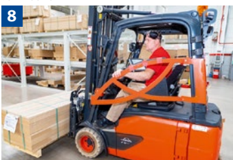
8 Gabelstapler erst verlassen, wenn der Antrieb stillgesetzt, die Feststellbremse angezogen, die Gabeln auf den Boden gesenkt wurde und der Schlüssel gezogen ist.
